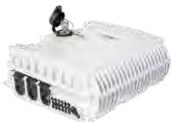
Caja distribución interior/exterior vacía, 3 puertos de entrada y 12 de salida de cable, sistema de cierre clamps y llave, capacidad para 12 adaptadores SC simplex o 6 LC dúplex, 1 charola para 12 fusiones. Contiene herraje a poste y mangas termocontráctiles. Dimensiones: 23.5 x 20 x 9.1 cm
