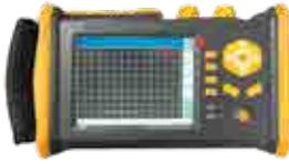
Identificador auditivo de cable de fibra óptica monomodo para 50 u 80 km, longitud de onda 1310/1550 ± 20 nm; conector FC/APC.
