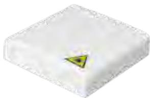
Caja terminal interior vacía, 4 puertos (2 puertos de entrada y 2 para salida de cable), capacidad para 2 adaptadores SC simplex o 1 LC dúplex. Espacio para 2 fusiones. Dimensiones 8.6 x 8.6 x 1.9 cm.
